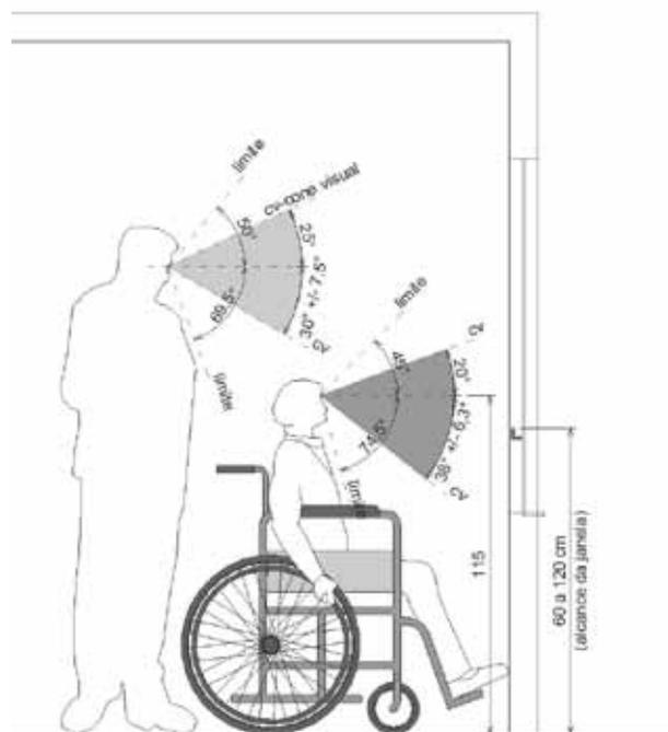
Figura 58 – Alcance visual pra instalação de janelas \*dimensões em cm
