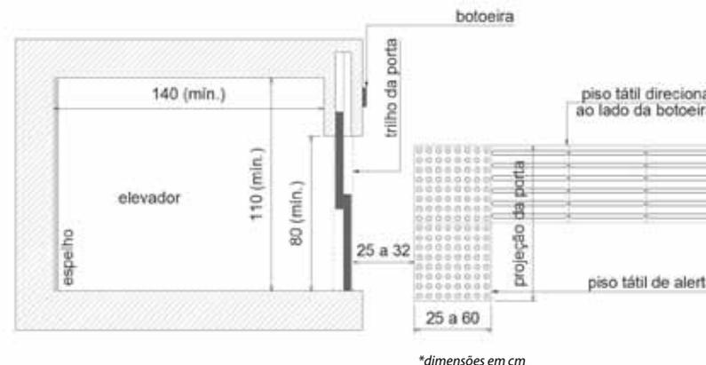
Figura 52 – Detalhes construtivos para elevador
