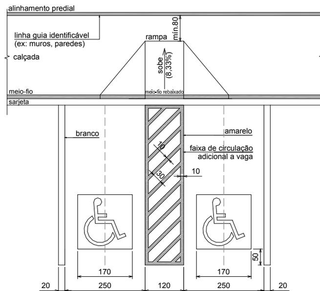
Figura 38 – Vaga de estacionamento em 90° com a calçada
