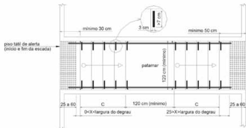
Figura 50 – Detalhes construtivos de escada (L<240cm)
