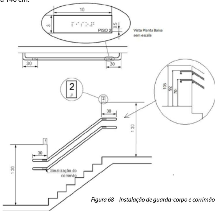
Figura 68 – Instalação de guarda-corpo e corrimão
