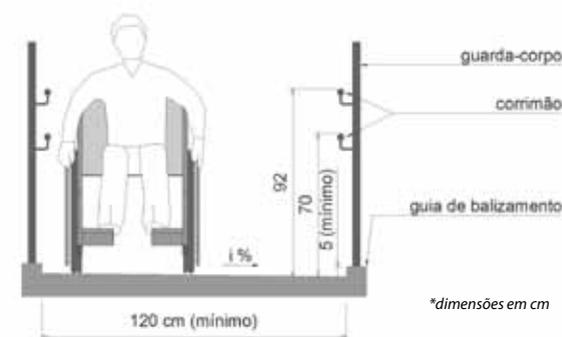
Figura 48 – Detalhe construtivo da rampa – vista frontal
