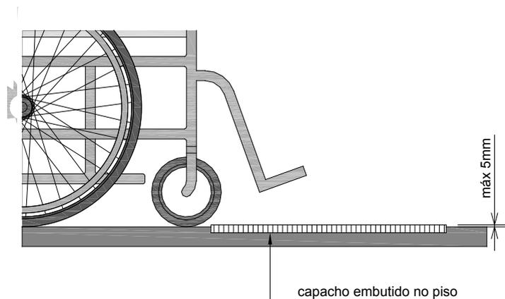
Figura 44 – Instalação de capachos embutidos
