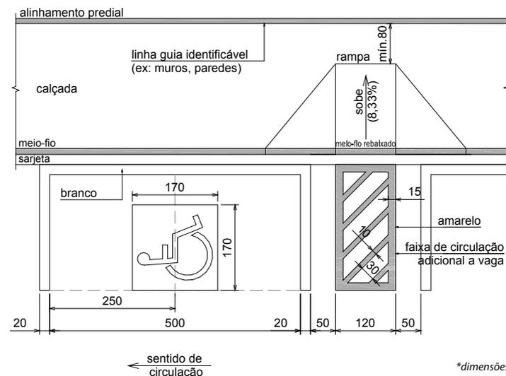
Figura 36 – Vaga de estacionamento paralela a calçada
