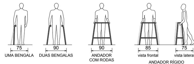
Figura 7 – Dimensões referenciais para deslocamento de pessoas com bengala e andador \*dimensões em cm
