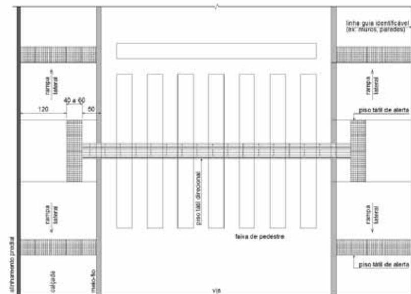
Figura 33 – Travessia de pedestre com utilização de faixa de sinalização direcional \*dimensões em cm
