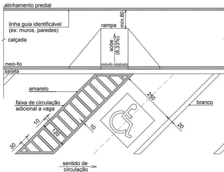
Figura 37 – Vaga de estacionamento a 45° com a calçada
