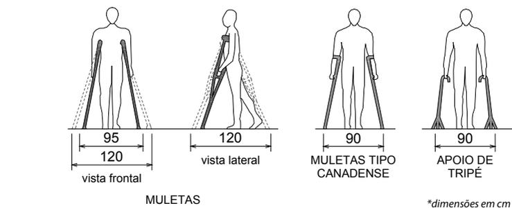
Figura 8 - Dimensões referenciais para deslocamento de pessoas com muletas
