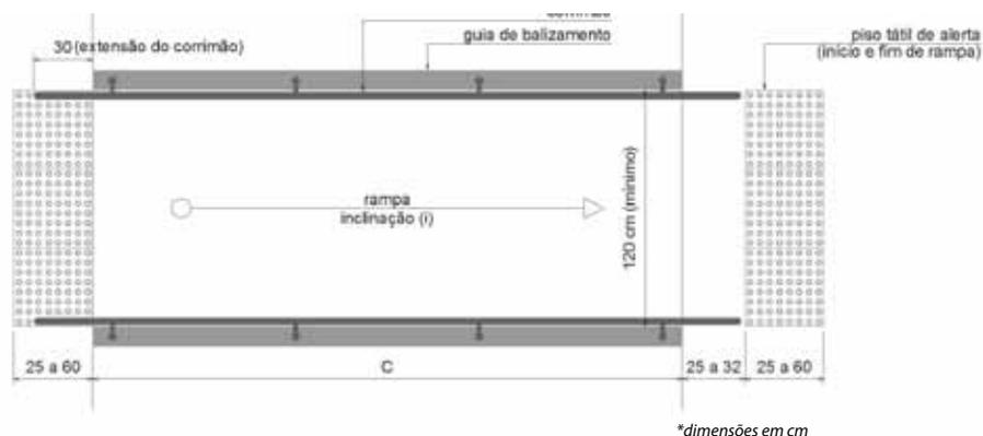
Figura 47 – Detalhe construtivo da rampa – vista superior
