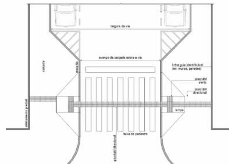
Figura 34 – Travessia de pedestre com avanço da calçada sobre a via \*dimensões em cm
